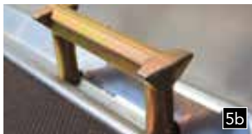
5b Bindringen in zijrand geïntegreerd (TUV goedgekeurd)
